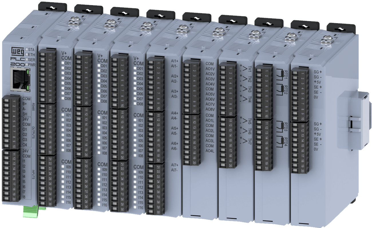
Figura 12.1: Ocho tarjetas de expansión conectadas
